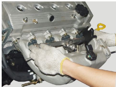
图2-137 喷油器和传输管安装到进气歧管的方法
