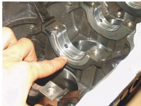
图2-83 在气缸体上安装止推垫片的方法
