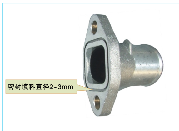
图2-149 出水口连接盘涂密封填料
