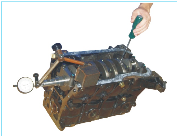
图2-78 测量曲轴轴向间隙
