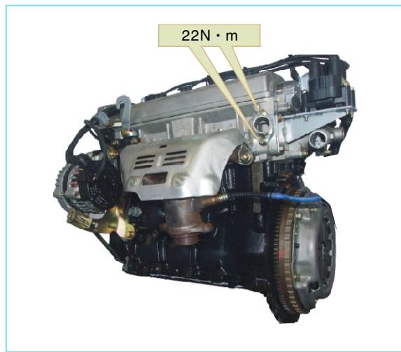
图2-150 出水口连接盘的紧固
