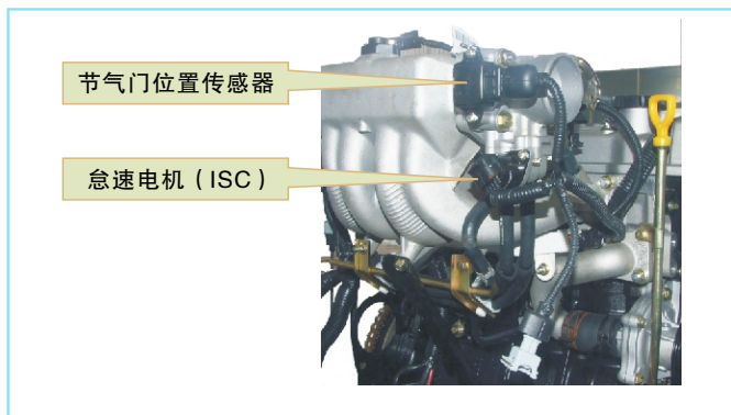
图2-143 连接节气门位置传感器和ISC接头
