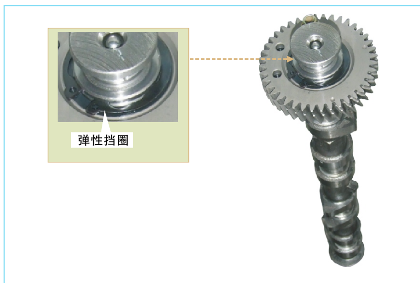
图2-107 安装进气凸轮轴上的弹性挡圈
