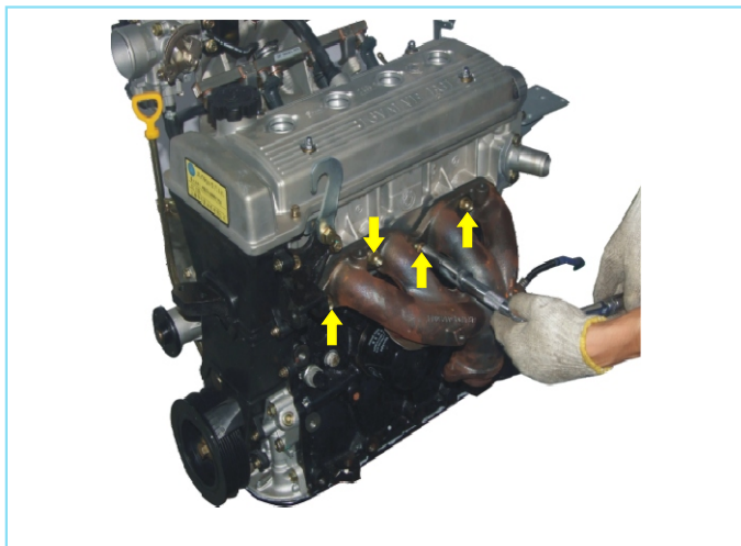
图2-151 安装排气歧管
