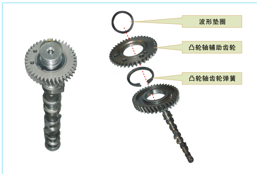
图2-106 进气凸轮轴安装注意事项
