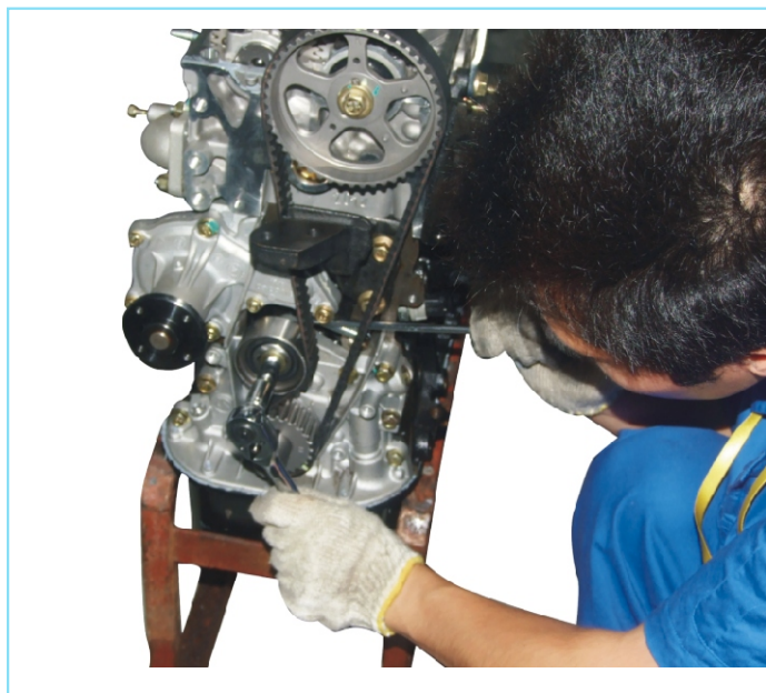
图2-127 调整正时皮带张紧度
