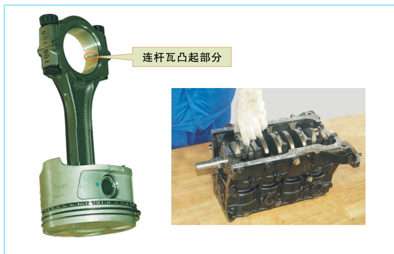
图2-91 安装连杆、连杆盖
