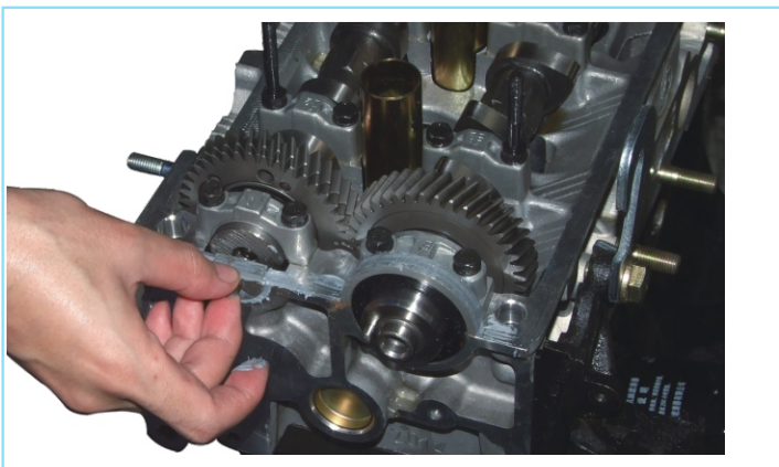
图2-130 将半圆塞装在气缸盖上
