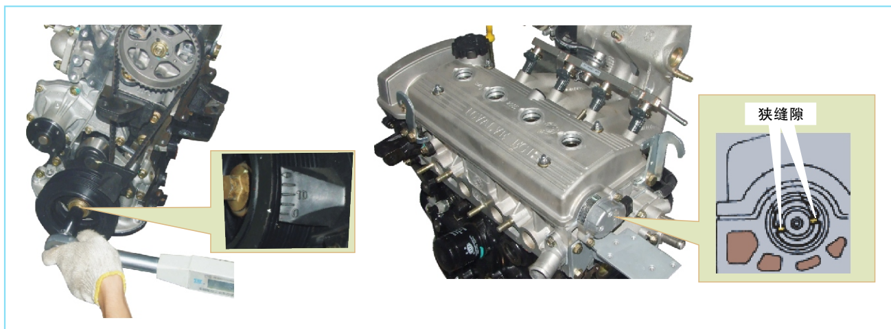
图2-146 设置1号气缸压缩行程上止点
