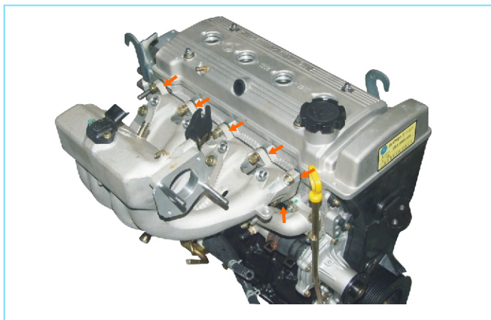
图2-134 安装进气歧管
