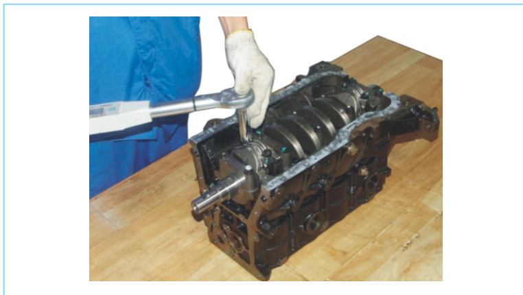
图2-92 连杆盖锁紧螺母的紧固
