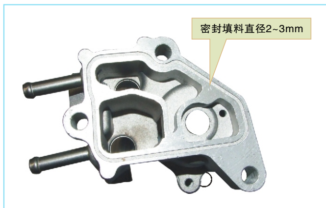
图2-144 进水口座底平面上涂密封填料
