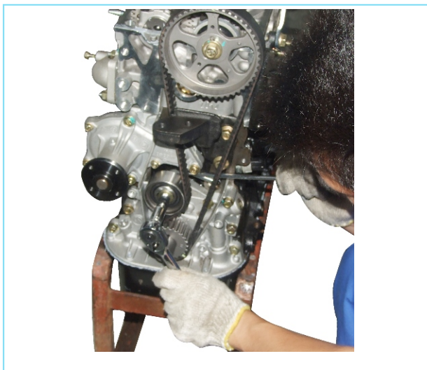
图2-124 检查正时皮带轮的张力
