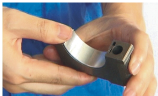
b) 在主轴承盖上安装止推垫片
