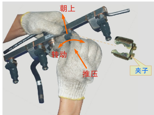
图2-136 在传输管上安装喷油器
