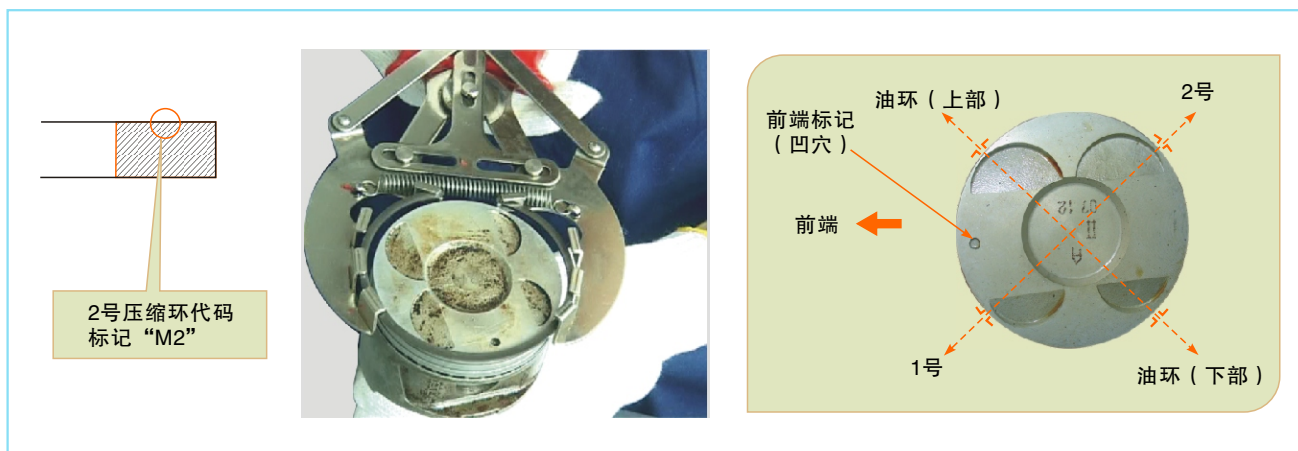
图2-90 气环、油环接口与缸体的相对位置
