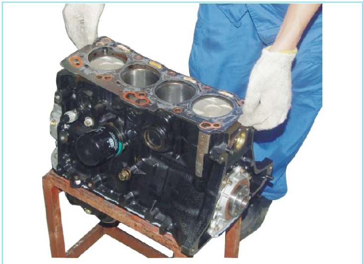
图2-103 安装气缸盖衬垫
