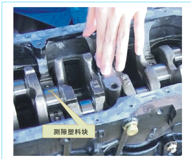
图2-74 放置测隙塑料块
