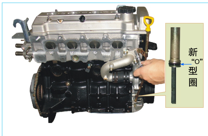
图2-133 新“O”形圈装到油标尺导管连接口上
