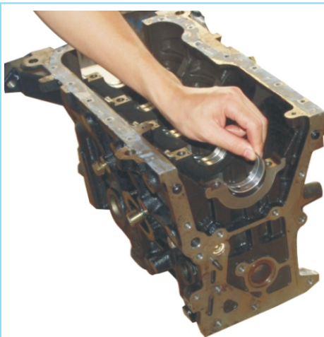
a) 在气缸体上安装主轴瓦
